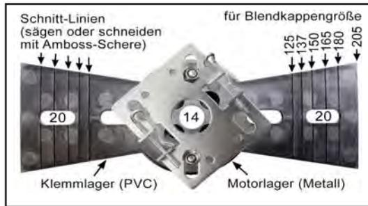
Vorbaukasten-/Klemmlager zur schraublosen Montage kann exakt auf das jeweilige Kastenmaß gekürzt werden geeignet für Blendkappengrößen von 125 - 205 mm
