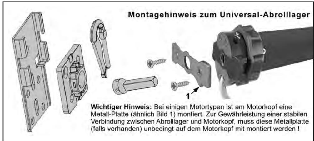
Abrolllager für Neubau-/Fertigkästen, Metall- / Kunststofflager, 4-teilig, ausrastbar / verstellbar, mit 10 mm Vierkantstift und 20 mm Rundbolzen
