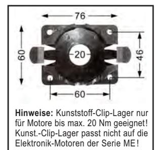
Vorbau-/Blendkappenlager aus Kunststoff Wandlager mit Clipsystem
