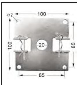
Kastenlager 100 x 100 mm mit Befestigungsbohrungen von 85 x 85 mm
