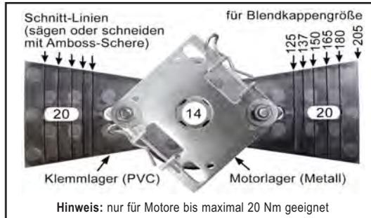
Vorbaukasten-/Klemmlager zur schraublosen Montage kann exakt auf das jeweilige Kastenmaß gekürzt werden geeignet für Blendkappengrößen von 125 - 205 mm
