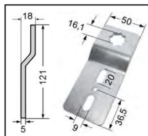
Neubau- / Fertigkastenlager
